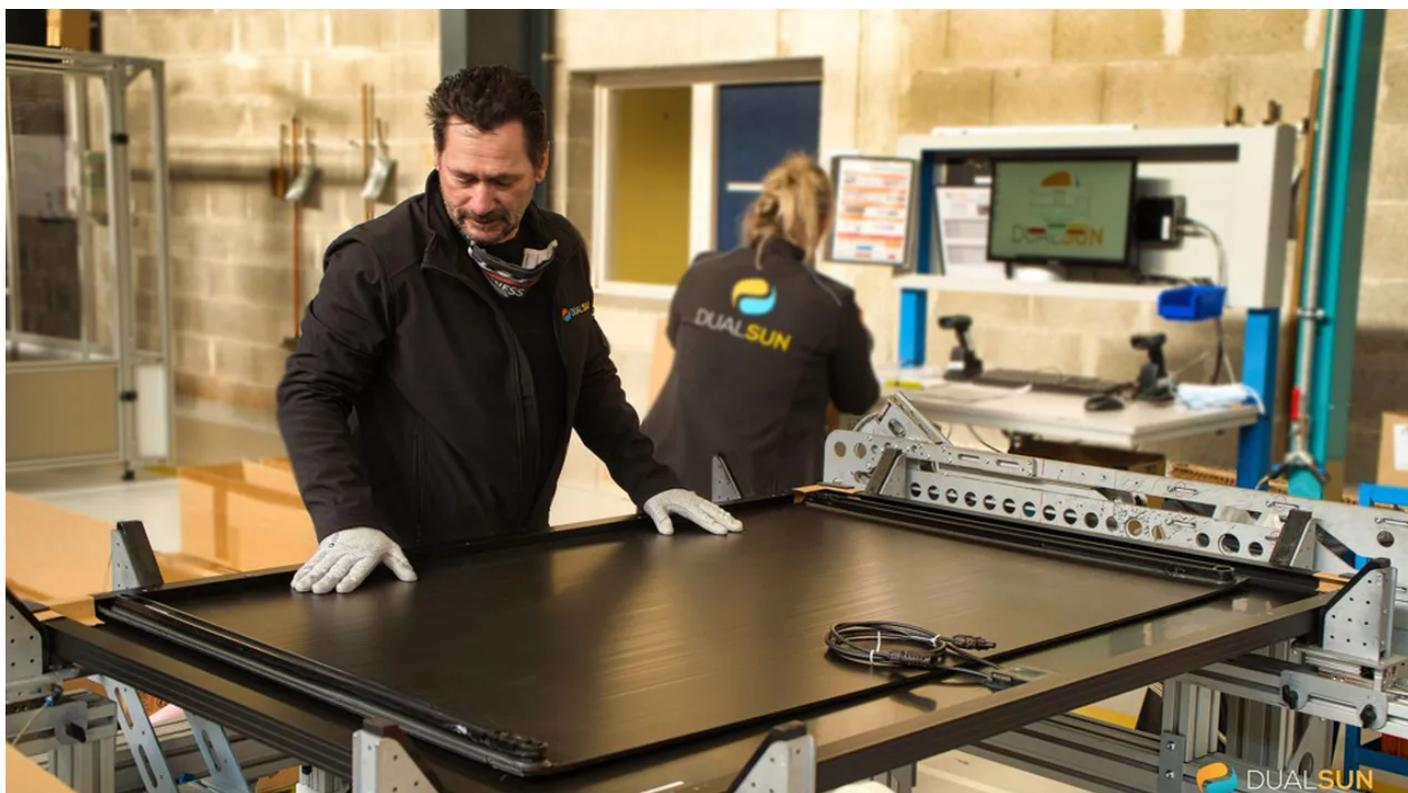
Le système de DualSun associe un échangeur thermique à un module photovoltaïque, dont l'assemblage est réalisé en France, près de Lyon. (DualSun)
